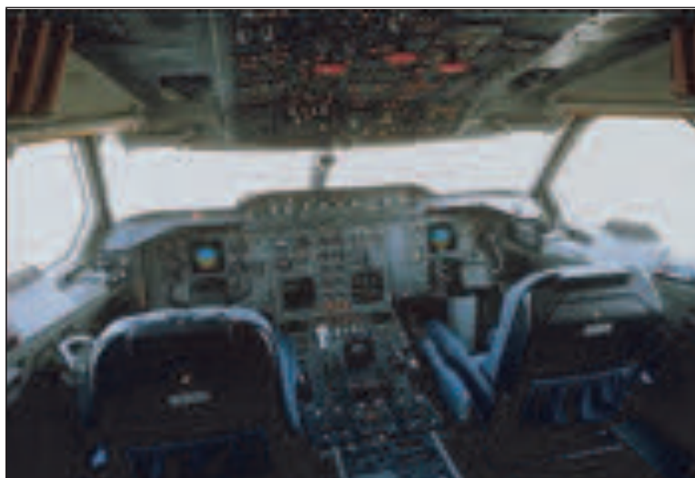
Figure 5 : Cockpit A 310 à 6 visualisations CRT 5"x5"
