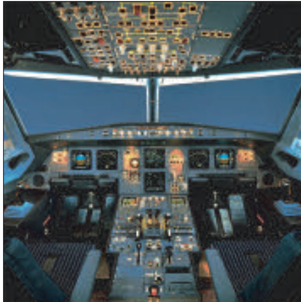
Figure 6 : Cockpit A 320 à visualisations CRT 6''x6''
